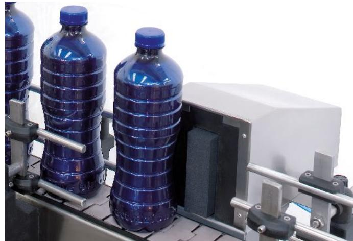
Une éponge de contact spécifique pour l'application est fournie en fonction du type de récipient (plastique ou verre) et du type d'élimination (sur table d'accumulation ou d'élimination). En cas d'exigences spéciales (par exemple formats extrasmall / extralarge ou élimination sur chaîne secondaire), il est possible de commander un système d'éjection personnalisé.
