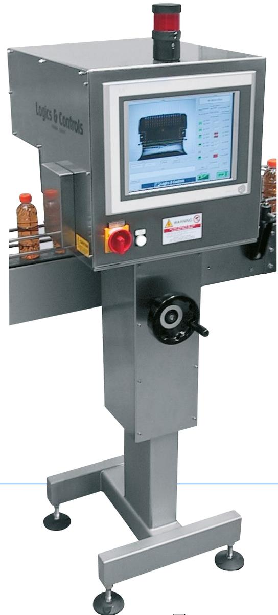
Logiclosure effectue des mesures extrêmement précises de n'importe quel point de l'image grâce à nos groupes optiques exclusifs qui éliminent l'effet de la perspective, donc l'erreur de parallaxe des optiques normales.
