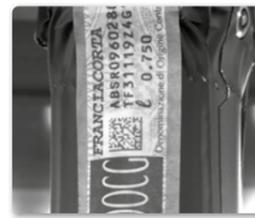
Réalise l'inspection complète, simultanée, à 360°, de toutes les étiquettes, de la capsule, des décorations et des ornements présents sur le récipient. Indépendamment de l'orientation de la bouteille, il effectue le contrôle de tout son habillage, moyennant une seule caméra à haute résolution et un groupe optique spécial conçu et produit
