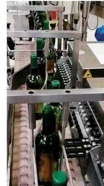
Le Logisort peut également être utilisé comme **système autonome de division continue** sur plusieurs rangées pour alimenter des machines de conditionnement.
